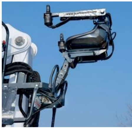
เบาน้ำคนขับพร้อมจอยสติ๊กแบบปรับสัดส่วนจาก Parker หรือ Danfoss ที่ต้องประกอบไว้ภายนอกพร้อมแผ่นป้องกันการรบกวน
